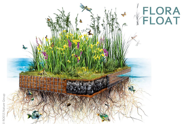
Bild 3: FloraFloat als modular aufgebaute, schwimmende Vegetationsinsel mit standortgerecht entwickelbarer Bepflanzung und frei in die Wassersäule reichendem Wurzelraum. Das System verbindet eine robuste, weitgehend kunststofffreie Tragstruktur mit Funktionen der Wasserbehandlung, Habitatbildung und ökologischen Aufwertung von Gewässern.
